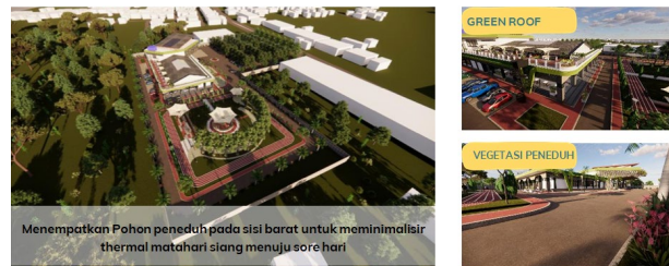
Gambar 13. Fasad Bangunan Dan Penerapan Arsitektur Hijau
